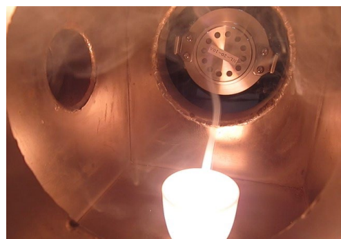
図 1. レーザー照射により微粒子を含むフュームが発生する様子
