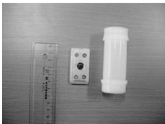
写真2 照射用ターゲットホルダーと搬送用キャプセル：ターゲットホルダー（左）は照射ターゲットを固定した状態。プラスチックキャプセル（右）
