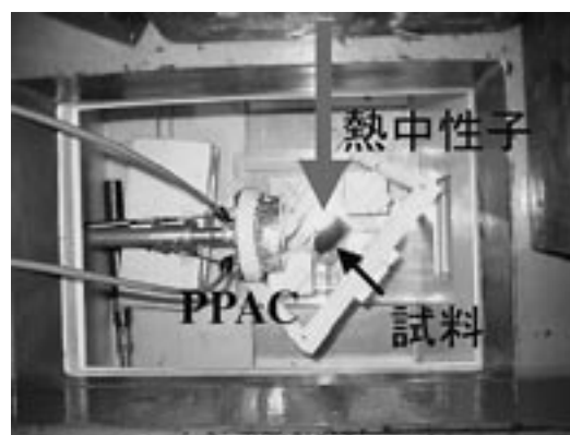
写真3 中性子インビーム・メスバウアー分光実験の試料とPPAC
