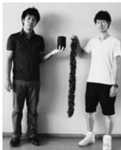
図3 フェロシアン化コバルト担持繊維の“組みひも”状集合体 (左は石原量君が持つ“ボビン”状、右は岡村雄介君が持つ“組みひも”状の吸着繊維集合体)
