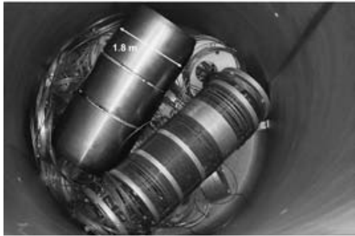
図3 加速器タンク底に崩落した加速管コラム (2011年3月23日確認)。ターミナル直径は1.8 mである。
