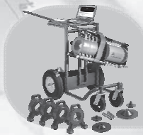
ISOCSTM : ガンマ線分析システム
