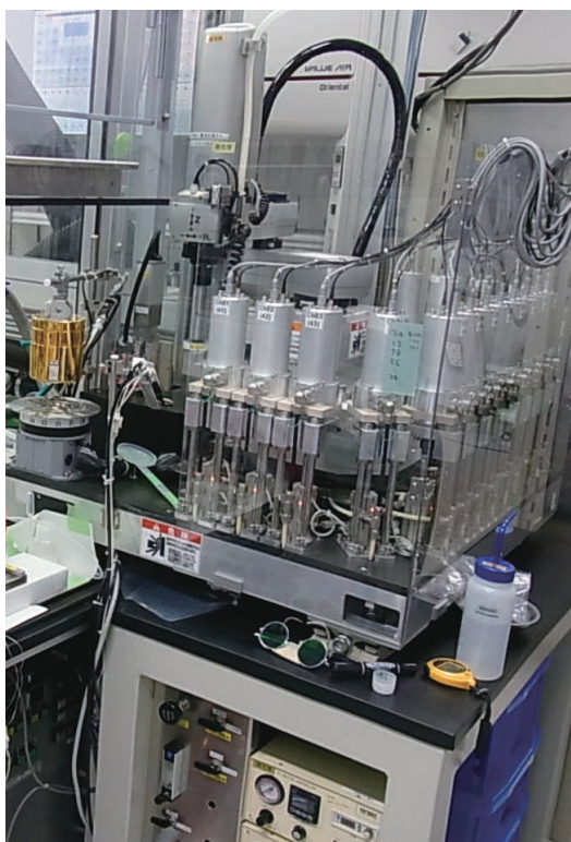
Fig. 5 理化学研究所における自動迅速 \alpha 線測定装置の写真
