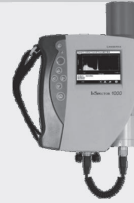
InSpector1000™ : 可搬型 デジタルスペクトロサバイメータ
